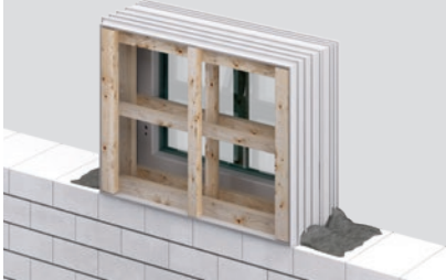
1. Fenster satt in Mörtel setzen.
